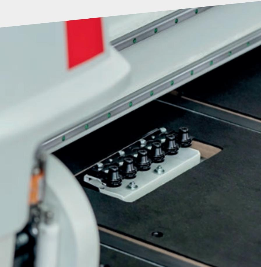
Das Werkzeugmagazin mit 6 Positionen gestattet die Ausführung von bis zu 3 verschiedenen Schnittarten (gerade, gebogen, offen gebogen) an der gleichen Scheibe. Dabei wird stets das am besten passende Werkzeug eingesetzt mit einer deutlichen Verbesserung der Qualität des Endergebnisses.
