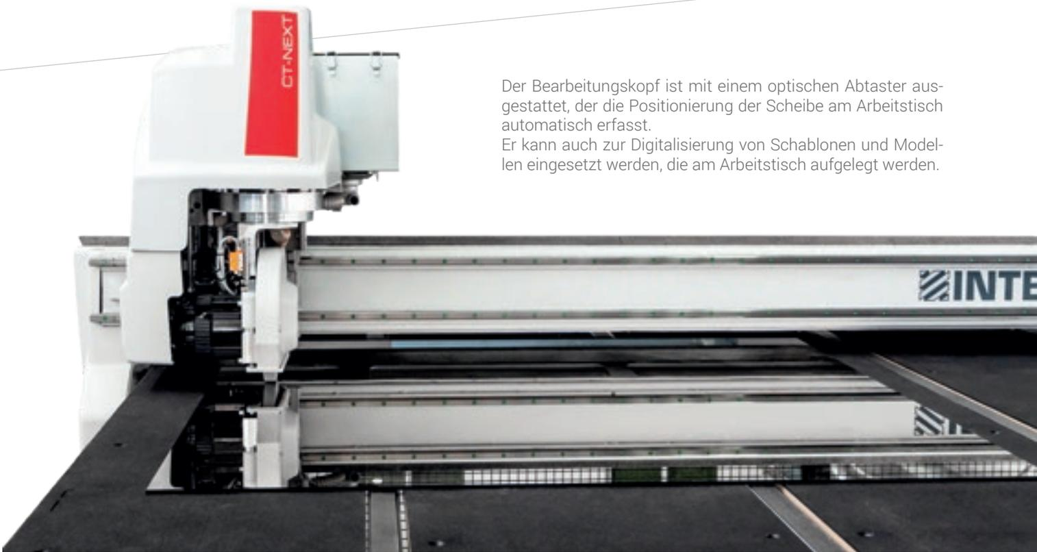
Qualitativer Präzisionsschnitt dank der Druckkontrolle durch ein Proportionalventil, das mit einem Display am Kopf ausgestattet ist.
