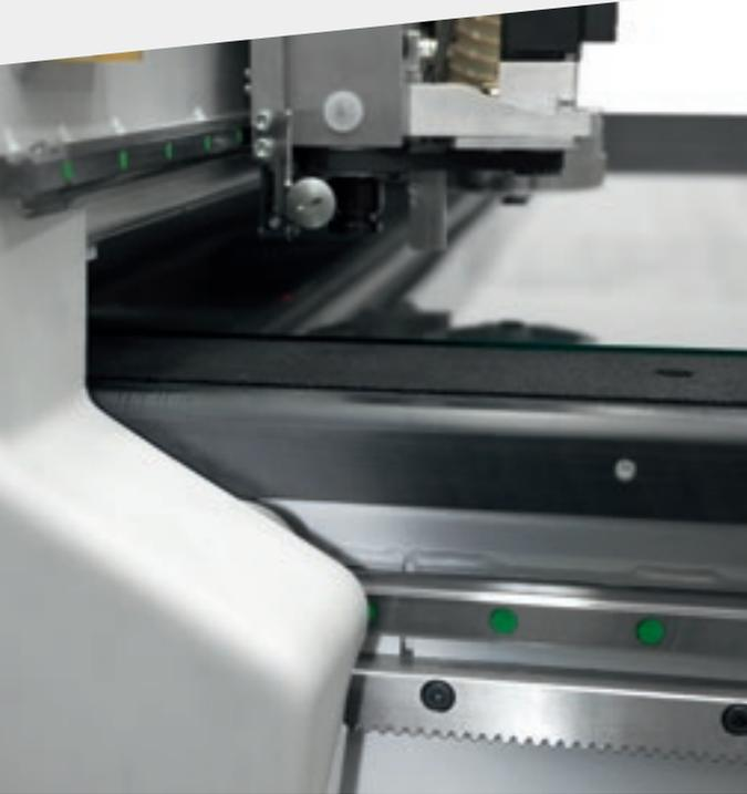
Das Maschinenbett besteht aus einer extrem robusten, festen (nicht schwingenden) Struktur mit integrierten Riemen.
