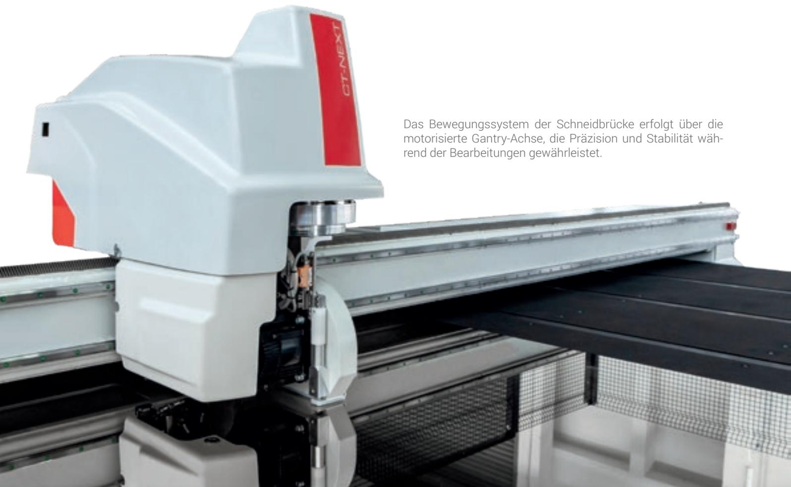
Das Bewegungssystem der Schneidbrücke erfolgt über die motorisierte Gantry-Achse, die Präzision und Stabilität während der Bearbeitungen gewährleistet.
