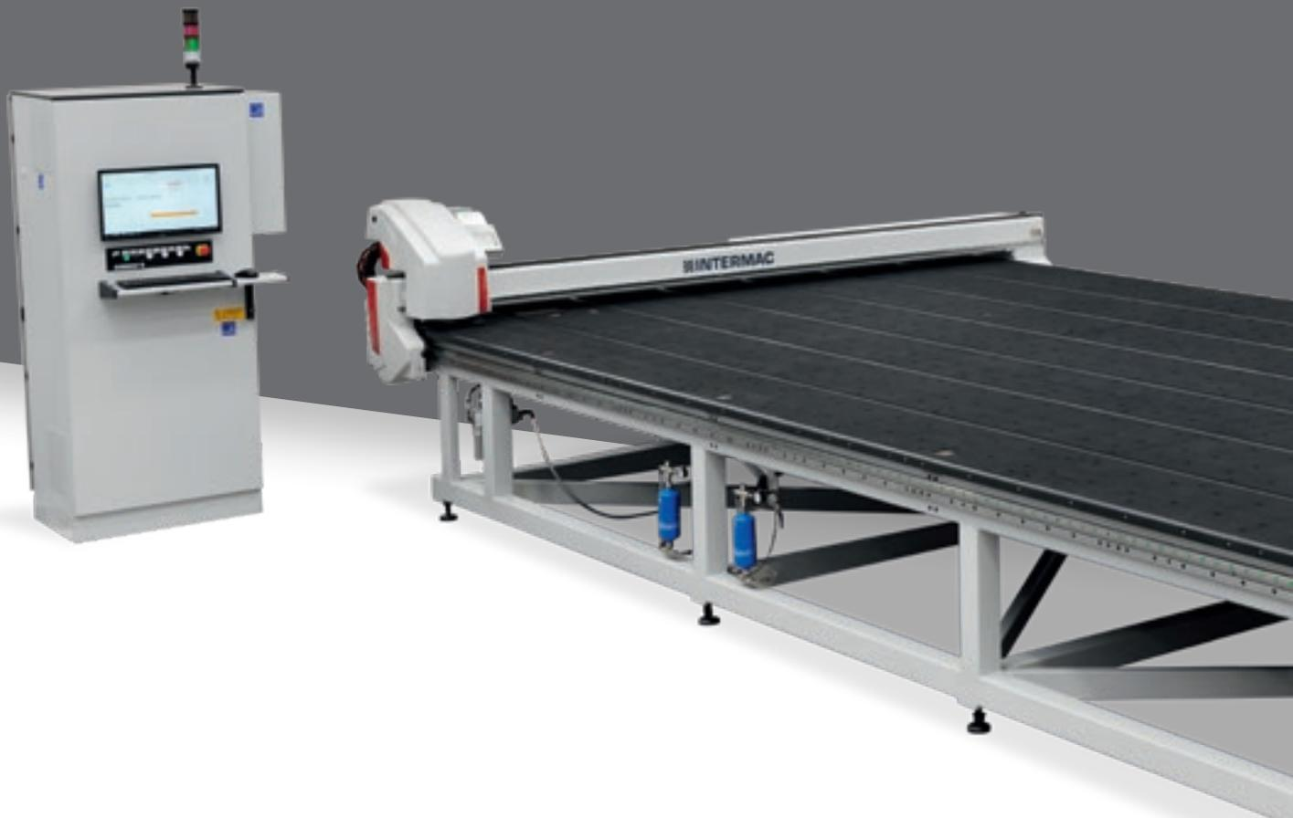
**Genius CT-NEXT** ist das Sortiment der 3-Achsen-Schneideti-sche für gerade Schnitte und Formfräsen von Flachglasschei-ben und perfekt für die Ergänzung durch Ladesysteme und die Einbindung in Schneidanlagen geeignet.
