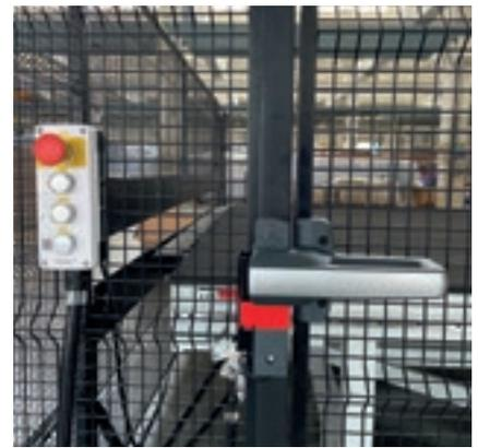
Die Durchgänge für den Ein- und Austritt der Glasscheiben sind mit Kontrollvorrichtungen ausgestattet, die den Durchlauf der Scheibe gestatten und ungewolltes Eindringen verhindern.
